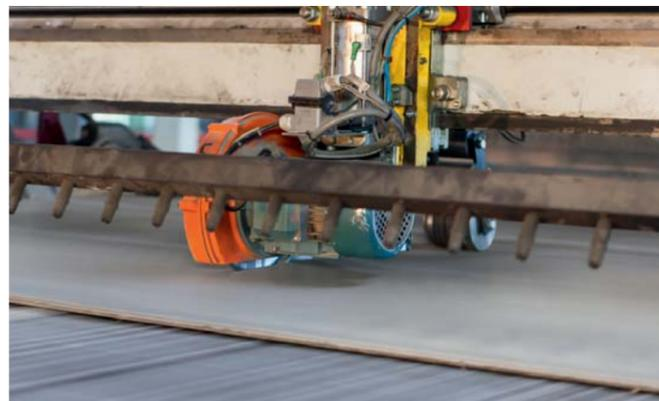
L'air comprimé est également présent pour la découpe des éléments de façade
